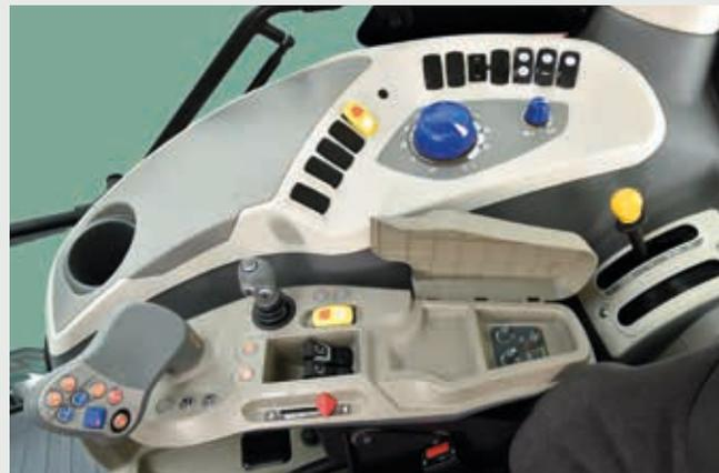
Kabineninterieur mit **VT-Drive** Getriebe: Die Bedienelemente befinden sich in die rechte Armlehne des Fahrersitzes integriert.
