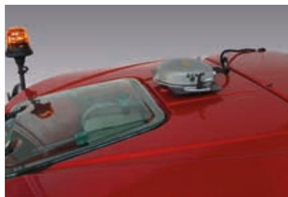
Die modulare All-in-One-Bauweise des AGI-4 umfasst Antenne, Empfänger und Lenkrechner in einer einzigen Komponente mit hervorragenden Upgrade-Optionen.
