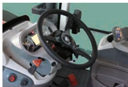
El volante electrónico permite un control preciso de la dirección durante los trabajos en campo abierto con un error máximo de 2 cm.
