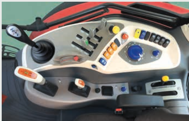
El interior de la cabina en la versión Xtrashift : los mandos del tractor están integrados en la consola a la derecha del conductor.
