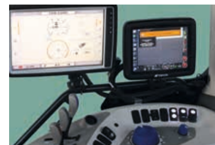
La pantalla táctil de 8,4" para la gestión del guiado por satélite y del control de apero ISOBUS.
