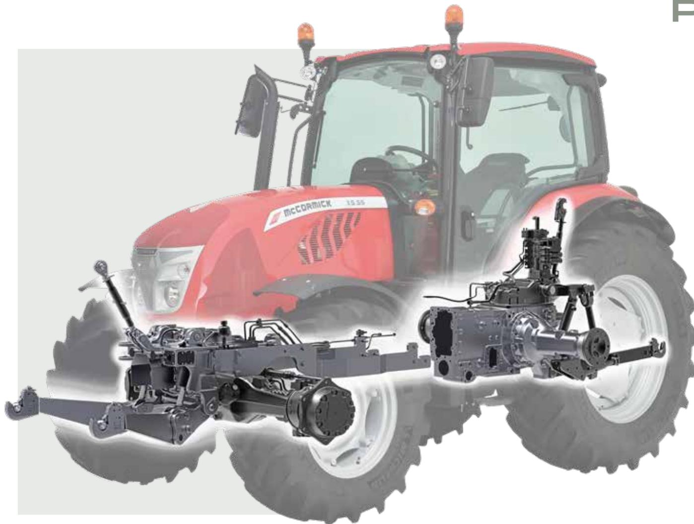
Il McCormick X5 è equipaggiato con un circuito idraulico a centro aperto capace di erogare 62 l/min, una portata che soddisfa la maggior parte delle esigenze di lavoro. Una pompa dedicata allo sterzo, con una portata di 32 l/min, permette di curvare in modo facile e leggero, anche durante gli impieghi più gravosi, a garanzia di un comfort e di una produttività sempre eccellenti.
