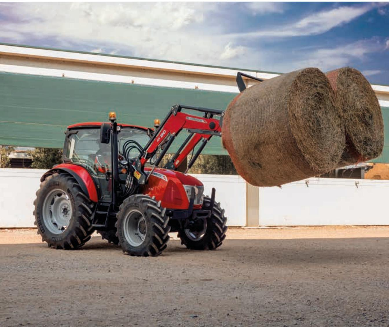
Progettati per essere integrati all'X5, i caricatori McCormick M80 sono realizzati in acciaio HLE ad alto limite elastico, capace di reggere carichi molto pesanti, grazie alle sue proprietà meccaniche. I punti di forza dell'M80:
