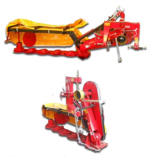
La altura de corte de la máquina es regulada por el brazo del tercer punto.
