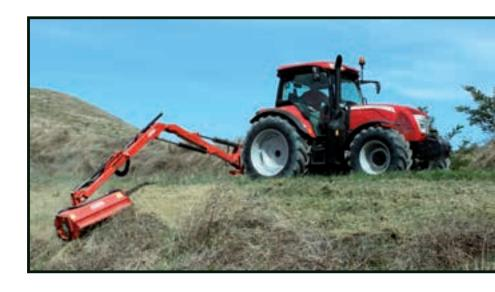
Entre las características técnicas más destacadas de los tractores X6 se encuentran una nueva transmisión Xtrashift 36/12 (3 gamas Powershift), un elevador trasero de control electrónico con capacidad de elevación de 5400 kg y una toma de fuerza con 4 velocidades (opcional). El circuito hidráulico ha sido mejorado y está disponible en versión estándar con un caudal de 66 l/min y en una versión con circuito cerrado (LS) que brinda un caudal de 110 l/min.
