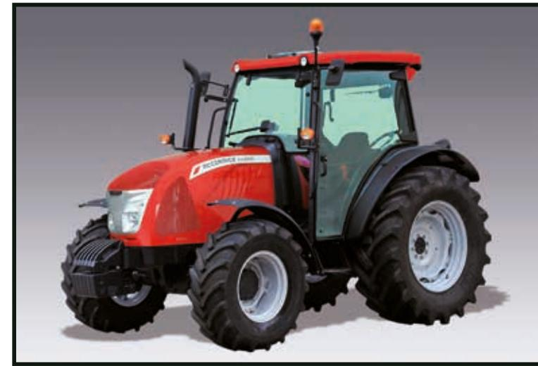
Die Allradversion ist mit elektrohydraulischer Allradzuschaltung ausgestattet und verfügt über eine mechanische Differentialsperre an der Hinterachse und über eine Differentialsperre „Limited Slip“ an der Vorderachse. Beim Betätigen der hydrostatischen Ringkolbenscheibenbremsen der Hinterachse schaltet sich der Allradantrieb automatisch zu. Gleichzeitig werden die Vorderachsbremsen aktiviert, wodurch eine sichere und effiziente Bremswirkung auf allen vier Rädern entsteht.
