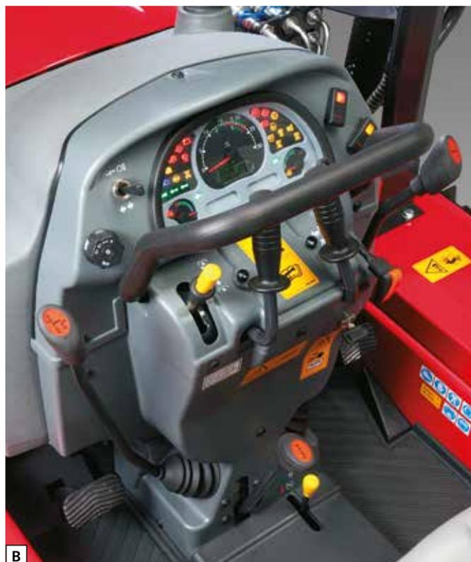
El elegante tablero mandos está equipado de instrumentos analógicos para una lectura simple y rápida. La transmisión modular con overdrive e inversor de serie proporciona 16AD+8MA. Opcionalmente, la transmisión puede equiparse de superreductor en lugar del overdrive. Las palancas de velocidades y de inversor se han rediseñado de forma más ergonómica y con un recorrido más corto que mejora el confort de conducción.
